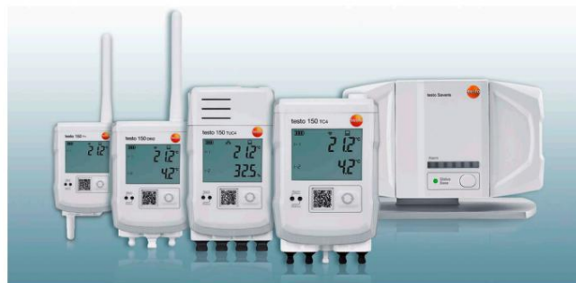
Figura 3: A função de alarme em etapas, em caso de violação de um valor limite (caixa à direita na imagem), é a maior vantagem do monitoramento ambiental totalmente automatizado.
