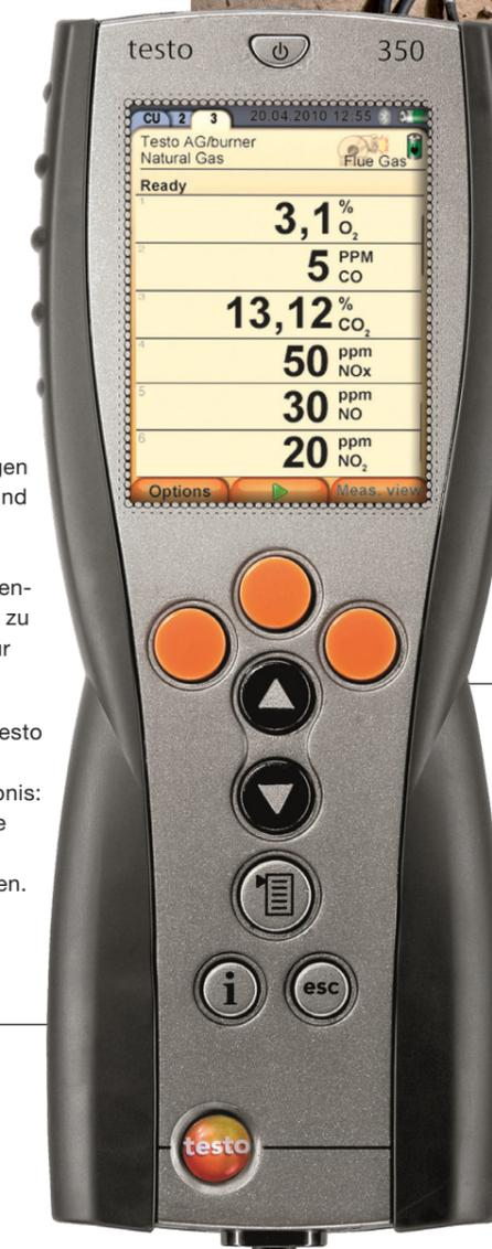
Präzise Sensorik und intuitive Bedienung – robust verpackt: Control-Unit in der Analysebox
