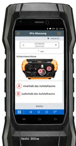
6. Schlauch, welcher am Rauchgas-Adapter angeschlossen ist, verbleibt im Rauminnen (Schlauch ungekürzt), Schlauch des anderen Differenzdruckknippel wird durch die Fensterdichtung (ggf. Rolläden öffnen), Türfalz oder Schlüsselloch nach außen gelegt.
