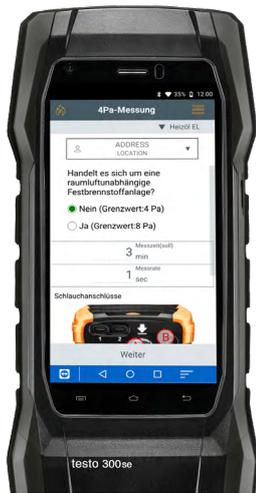
1. Abgasmessgerät testo 300 einschalten und Schlauchkapillare anschließen (Druckanschluss-Set 0554 1203 + Kapillarschläuche-Set 0554 1215).
