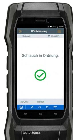
9. Messprogramm starten. Programm startet mit Selbsttest.
