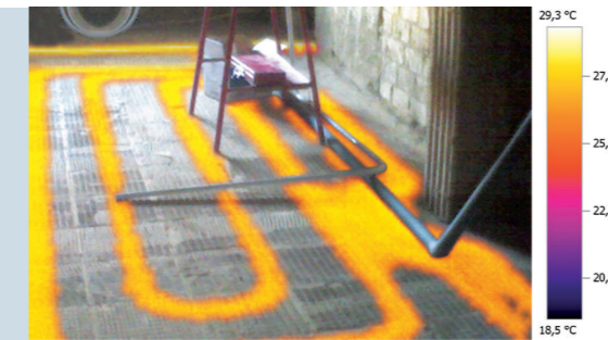
Détection des canalisations cachées également possible dans l'image réelle grâce à TwinPix
