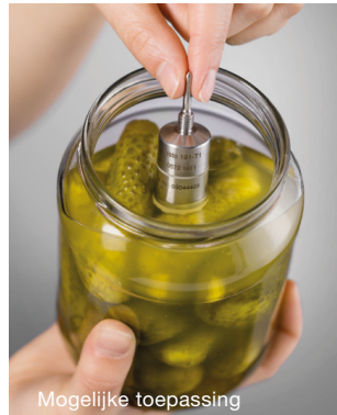
Temperatuurmeting direct in het levensmiddel: testo 191-T1
