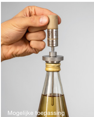
Temperatuurmeting in een blik/fles met externe bevestiging van de logger: testo 191-T2 + blik- en flesbevestiging
