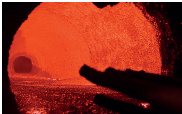
Fabrico de clinker (processo de calcinação).
