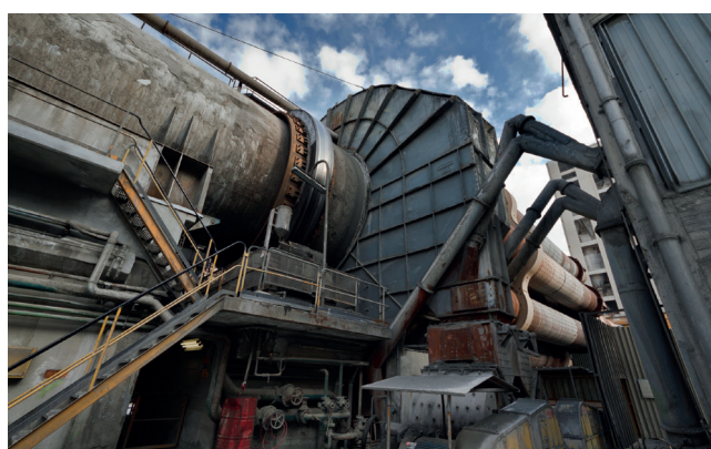
Queima d farinha na instalação de pré-aquecimento e no forno de tubos rotativos.
