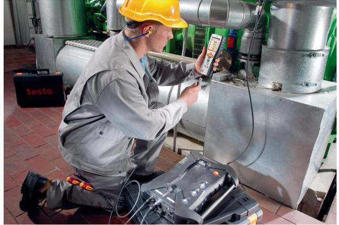
Preparación de una medición de control en una planta de cogeneración con el testo 350.
