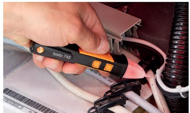
O **testo 745** resistente à água e poeira é um instrumento de detecção de tensão sem contato.
