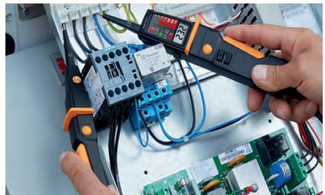
O testador de tensão **testo 750-3** possui um display LED integrado, um anel antiderrapante e uma alça ergonômica para uso confortável.
