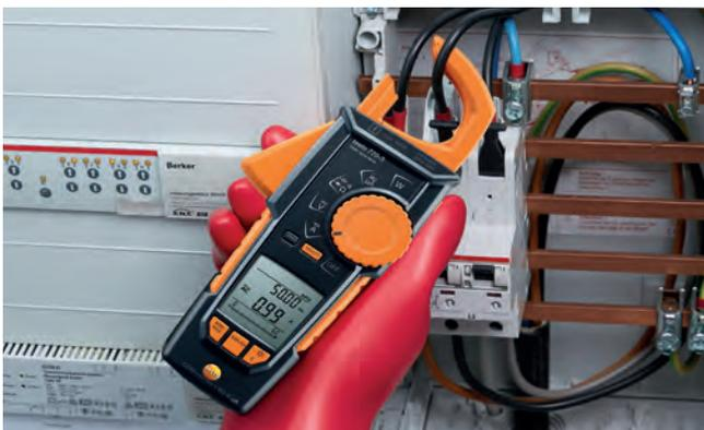
A medição sem contato em cabos pouco espaçados é realmente fácil e confiável com a pinça amperimétrica **testo 770-3**: um braço de pinça retrátil pode ser totalmente retraído.
