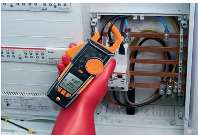
Medição da corrente no quadro de distribuição elétrica.
