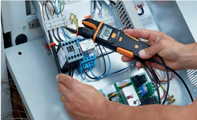
Testador de tensão e instrumento de medição de corrente em um: o **testo 755-2** é versátil para quase todas as tarefas de medição elétrica.
