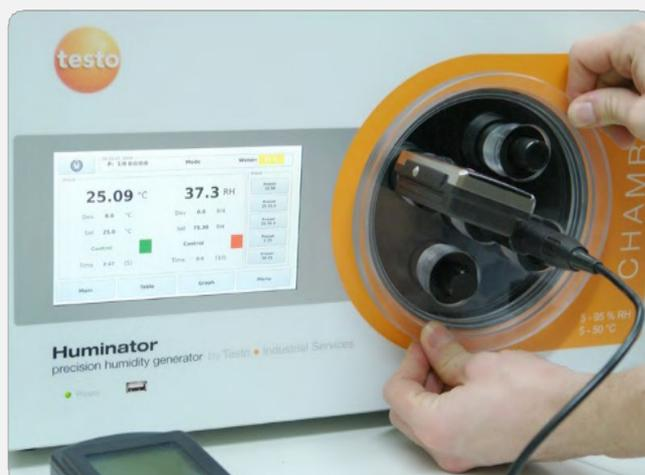
Huminator II はスピーディかつ正確に湿度校正をするために設計されています。
