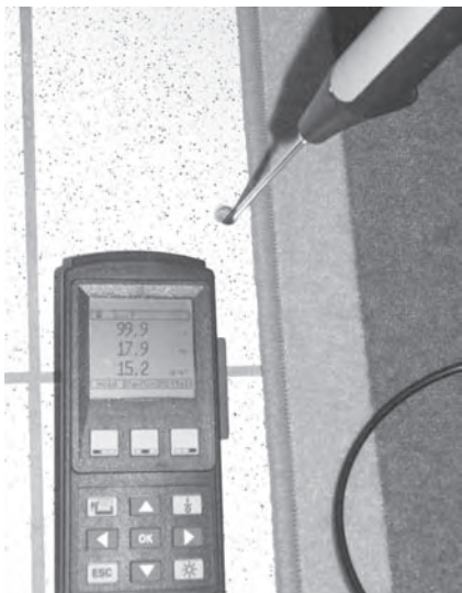
Fig. 20: Medición en un orificio de ensayo en un suelo embaldosado
