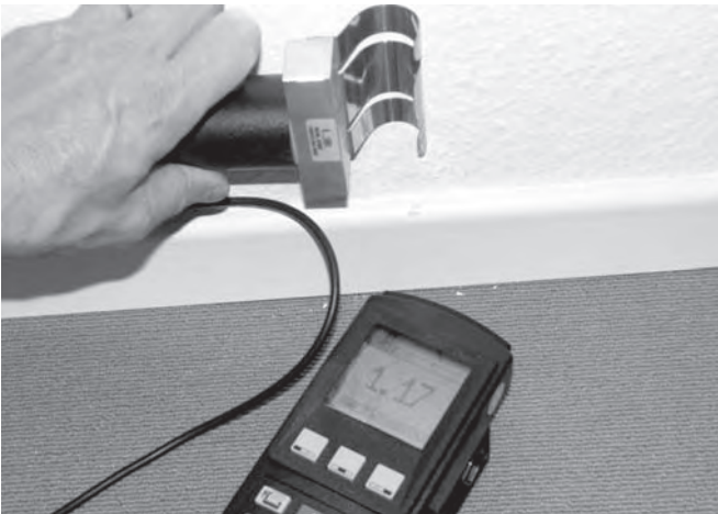
Fig. 10: Cómo sostener una sonda con cabezal de bucle
