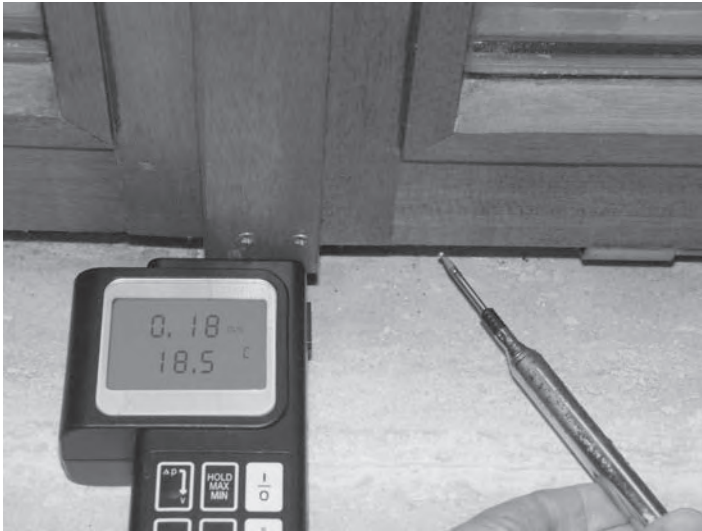
Fig. 24: Medición en una unión de ventana
