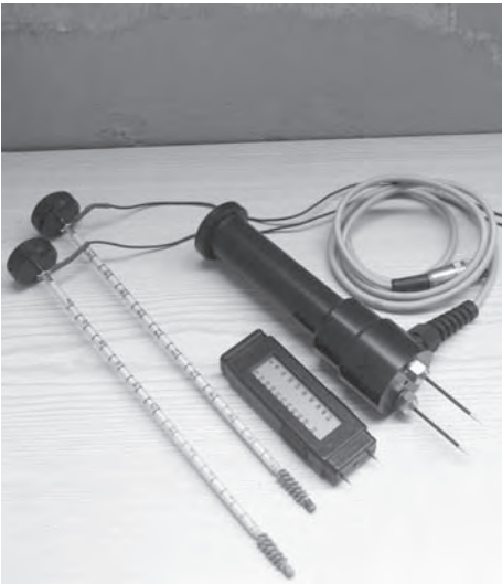
Fig. 12: Tipos de sondas para medir la conductividad
