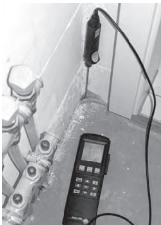
Fig. 7: Medición en uniones de encofrado
