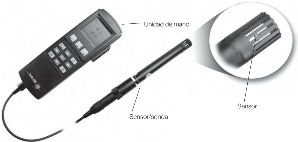
Fig. 1: Componentes de un instrumento de medición
