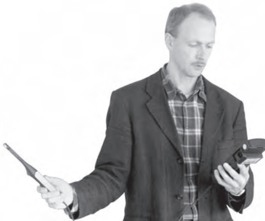
Fig. 2: Manipulación correcta al medir la temperatura y la humedad del aire
