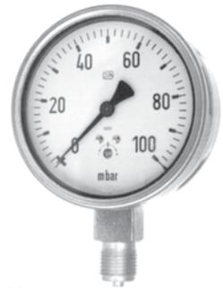
Los manómetros mecánicos se caracterizan por su resistencia y por su sencillo manejo. También tienen un coste de fabricación relativamente barato. Pero tienen algunas desventajas. La deformación mecánica significa que existe un riesgo de que la fatiga del material evite que el resorte retorne a su posición original. La función de retorno del resorte a su posición original también se llama histéresis (ver punto 9.4).
