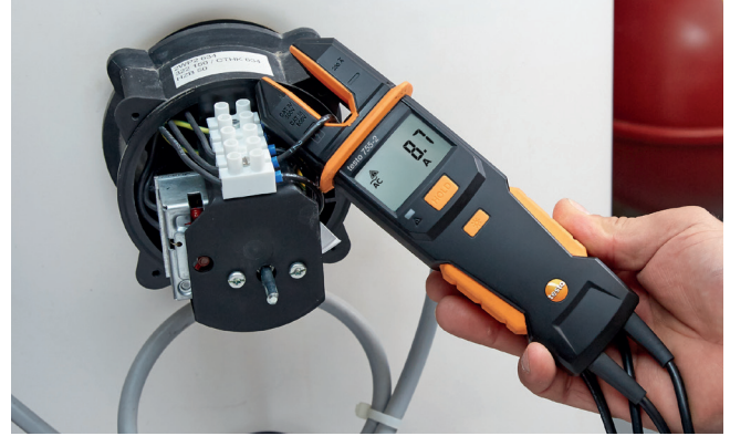
Otomatik ölçüm parametresi tanıma, değiştirilebilir ölçüm uçları ve 1000 V'a kadar voltaj aralığı özelliklerine sahiptir.
