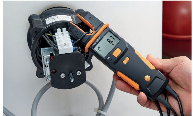
Mérési paraméterek automatikus felismerése, cserélhető mérőcsúcs és feszültségmérés 1000 V-ig.
