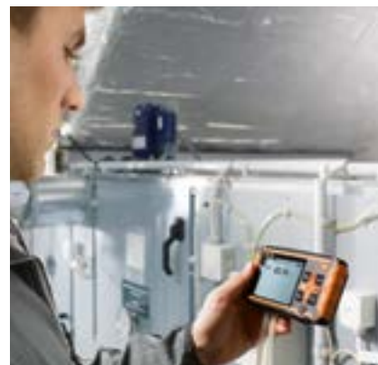
Verschildrukmeting met aansluitslang
