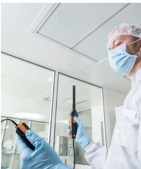
Sie müssen auch in Umgebungen messen, wo Bluetooth nicht möglich ist? Kein Problem: Einfach den Sondenkopf vom Bluetooth- auf den Kabel-Handgriff stecken und fertig.
