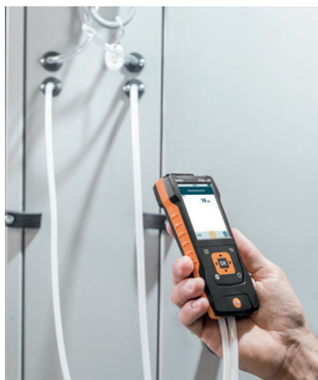
Mit dem Modell testo 440 dP inkl. Differenzdruck-Sensor stellen Sie sicher, dass die Filter von Klimaanlage ordnungsgemäß funktionieren und kein Schmutz der Außenluft in die Raumluft gelangt.
