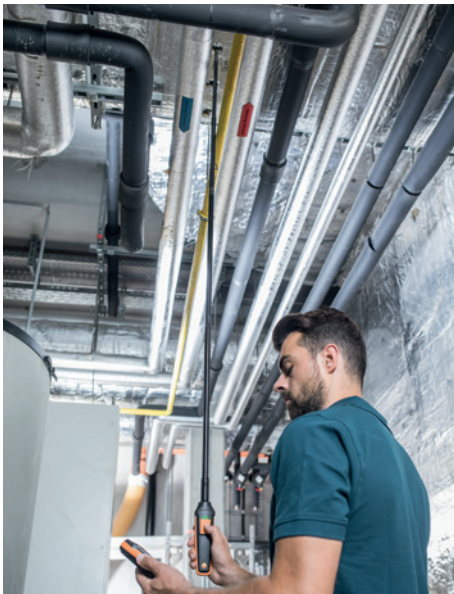
Alle testo 440 Strömungssonden für Messungen im Kanal haben ein skaliertes, ausziehbares Teleskop (optional von 1 m auf 2 m verlängerbar).
