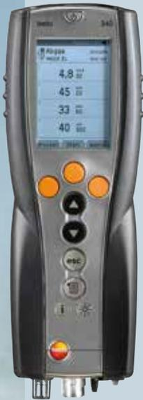
Das **testo 340** ist das ideale Handmessgerät für die industrielle Abgasanalyse. Besonders kompakt gebaut, kombiniert es zuverlässige Technik und höchste Mobilität – und ist damit perfekt für internationale Serviceeinsätze sowie die Inbetriebnahme und Kontrolle von industriellen Feuerungs- und Energieerzeugungsanlagen.
