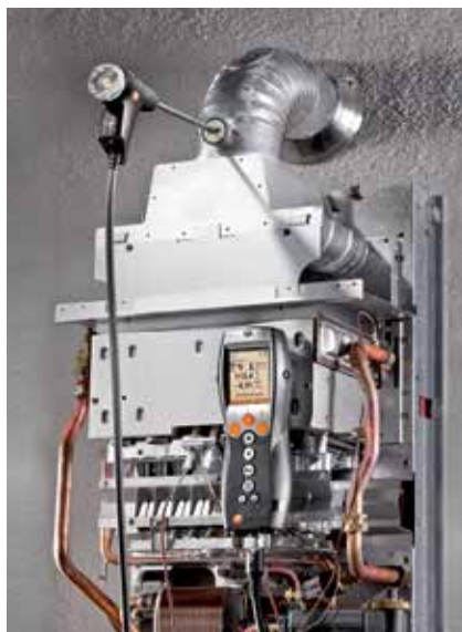
Fig. 8: Para los trabajos de ajuste es imprescindible un analizador de combustión, p. ej. el testo 330 LL
