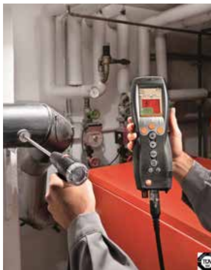
Fig. 16: Con el analizador de combustión testo 330 LL se miden los productos de la combustión.
