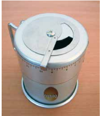
Fig. 20: caudalímetro para determinar el caudal de agua de la caldera.
