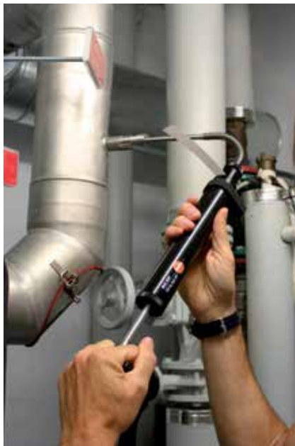
Fig. 22: bomba de opacidad manual para determinar el número de la opacidad
