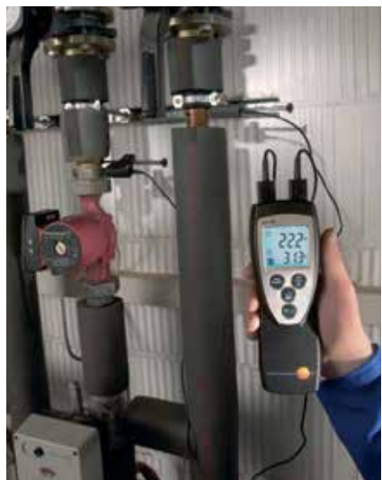
Fig. 21: termómetro digital para determinar la temperatura diferencial ( \Delta t )
