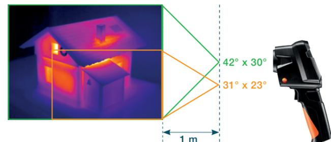
**IFOVgeo** est indiqué en milliradian (mrad) et décrit le plus petit objet pouvant encore être représenté par un pixel sur l'image thermique et affiché à l'écran, en fonction de la distance de mesure. Qu'est-ce que cela veut dire ? A une distance de 1 m, avec une résolution du détecteur de 160 x 120 pixels et un FOV de 31°, l'IFOVgeo est de 3.4 mrad. Un pixel représente donc un spot de mesure d'une longueur de côté de 3,4 mm qui est affiché à l'écran de la caméra.
