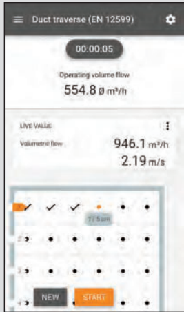
ダクト風量測定をグラフィカルにサポート
