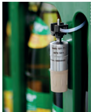
Měření okolní teploty: testo 191-T1 + upevňovací svorka a kabelová páska (kabelová páska není součástí dodávky)
