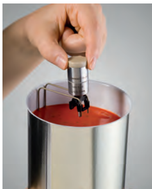
Měření teploty v plechovkách: testo 191-T1 + stojánek
