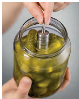
Měření teploty přímo v potravinách: testo 191-T1
