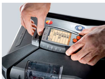
Jednostka sterująca jest montowana przez „kliknięcie”
