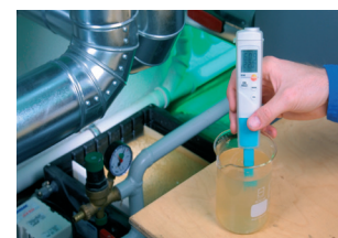
testo 206-pH1 odpowiedni do monitorowania wody w systemie grzewczym zgodnie z VDI 2035
