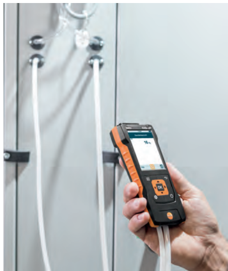
S modelem testo 440 dP vč. senzoru diferenčního tlaku zjistíte, že filtry klimatizačního zařízení řádně fungují a že se do vzduchu v místnostech nedostávají nečistoty z venkovního ovzduší.
