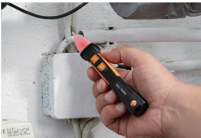
初步检测电源电压
