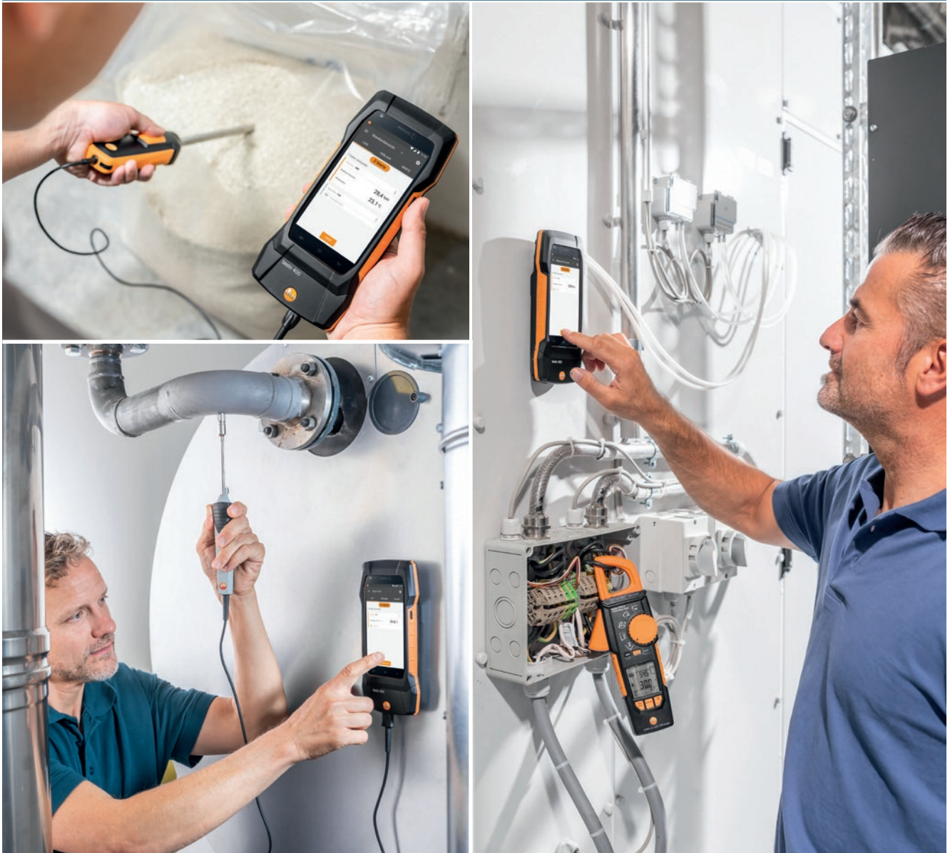
testo 400可以同时连接并使用多达8个探头 (4个蓝牙探头, 2个有线探头、2个K型热电偶)
