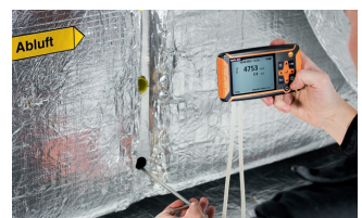
testo 420 并非单一风量测量功能, 其主机可作为单独绝压、压差测量仪进行管道压力、风速、风量检测, 还具备温湿度测量功能, 一机多用, 专业通风系统检测工具。
