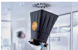
testo 420 专业风量罩 大型涡流出风口风量、温度和相对湿度测量
