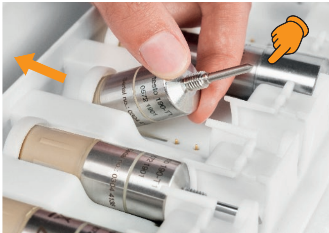
ソケット下部をスライドさせ簡単設置
