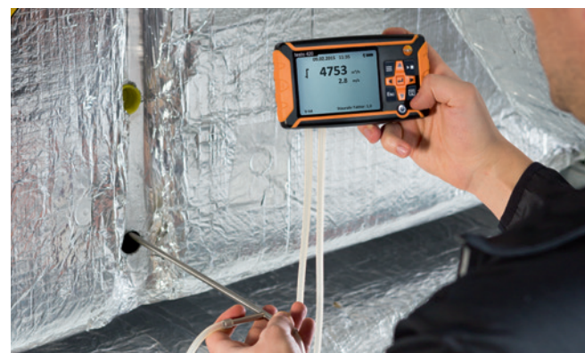
Dankzij het afneembare instrument kunnen pitotbuis-metingen in het kanaal worden uitgevoerd (pitotbuis apart verkrijgbaar)
