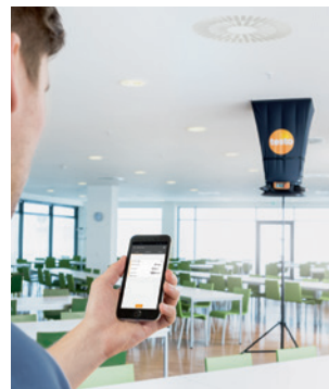
App-koppeling via bluetooth voor weergave van de meetgegevens op mobiele apparaten en afmaken op het meetrapport op locatie.
