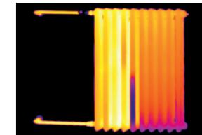
**Assurer le bon fonctionnement et la qualité :** identifier en un clin d'œil des défauts au niveau des radiateurs.
