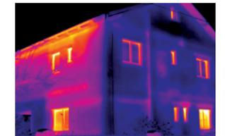
**Détecter les pertes d'énergie des bâtiments :** détecter et visualiser instantanément les ponts thermiques de façades ou à l'intérieur des bâtiments.
