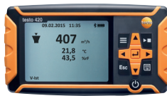
testo 420 - Fark basınç ölçüm cihazı
