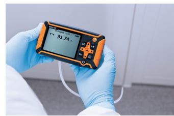
Bağlantı hortumu ile fark basınç ölçümü
