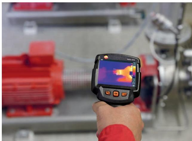
Les installations électriques et mécaniques des systèmes de cogénération\* peuvent être inspectées en service et à une distance sûre à l'aide d'une caméra thermique pour découvrir des points critiques et réduire les pannes de l'installation, augmenter la durée de vie et utiliser l'énergie de manière encore plus efficace. Comparée au coût d'une panne de fonctionnement, la maintenance de l'installation avec une caméra thermique est extrêmement rentable.
