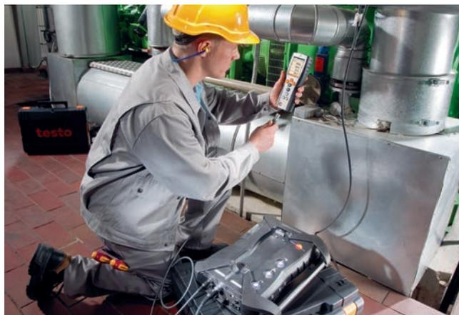
Préparation d'une mesure de contrôle sur une centrale de cogénération au moyen d'un testo 350.
