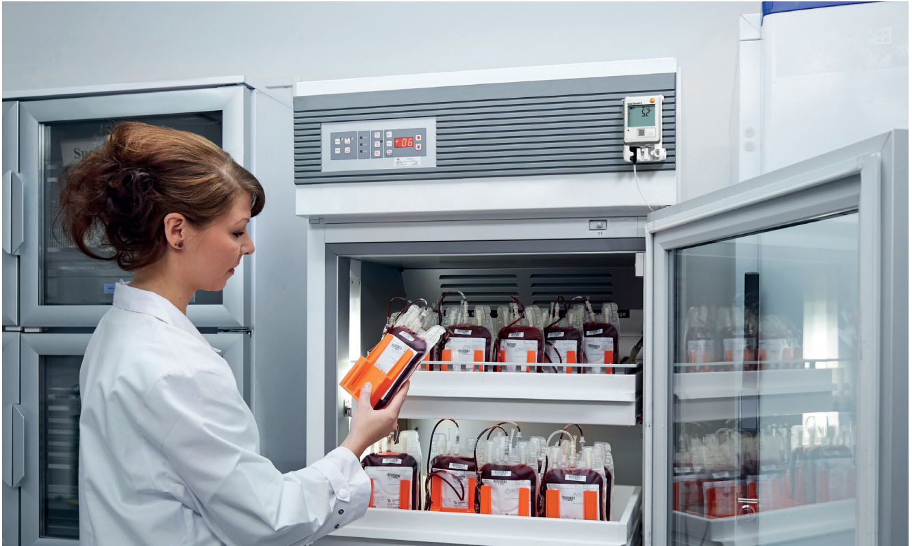
Un data logger WiFi monitorizează temperatura dintr-un frigider cu resurse sanguine și alarmează personalul atunci când apar abateri de la valorile standard.
