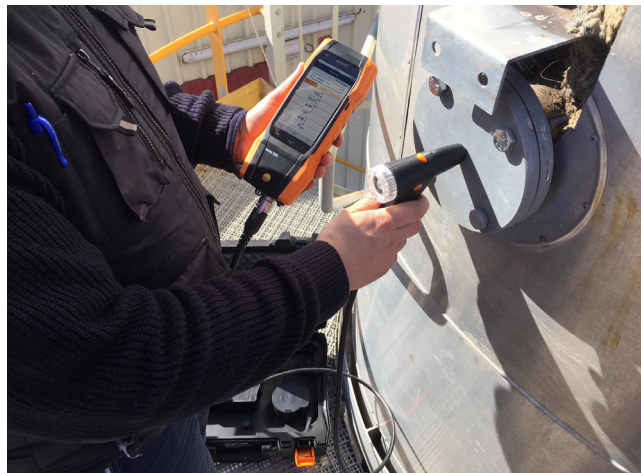
Medición de O 2 y NO para comprobar que los valores estén dentro de lo establecido por la AAU.
