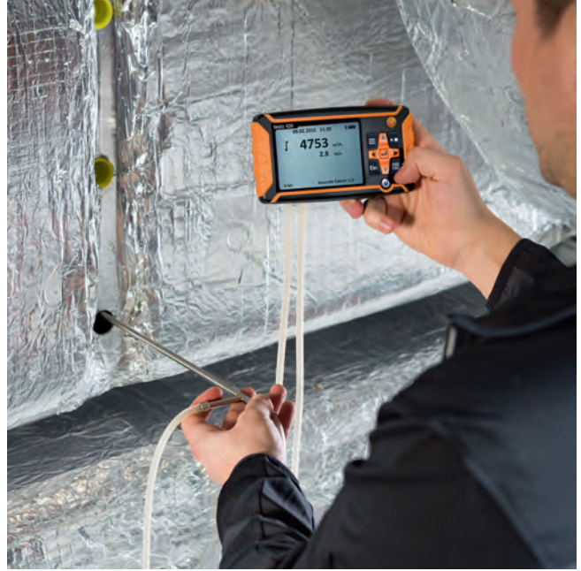
Instrumento de medición extraíble para poder realizar mediciones con tubo Pitot en el canal (el tubo Pitot se puede adquirir por separado)
