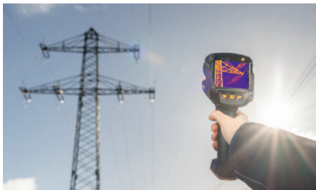
Sprawdzanie połączenia zacisku na izolatorze
