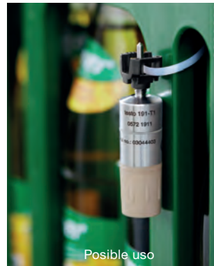
Medición de la temperatura ambiental: testo 191-T1 + Abrazadera y sujetacables (el sujetacables no está incluido en el volumen de suministro)
