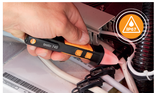
Wodoodporny i pyłoszczelny tester napięcia testo 745 to solidny i wytrzymały przyrząd, który pomoże ci w codziennej pracy.
