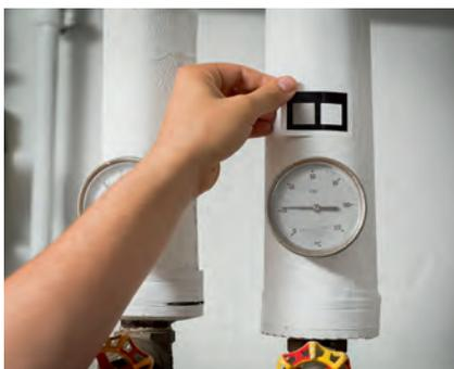
Pegue no **testo  $\epsilon$ -marker** e capte o objeto com a câmara digital da câmara termográfica.
