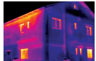
**Deteção das perdas de energia em edifícios:** Detecção e ilustração imediatas de pontes térmicas em fachadas ou no edifícios.
