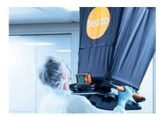
Gran exactitud al realizar mediciones en los difusores de salida de aire gracias al estabilizador de caudal
