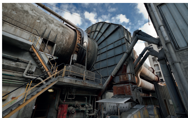
Wypalanie surowego granulatu w piecu obrotowym
