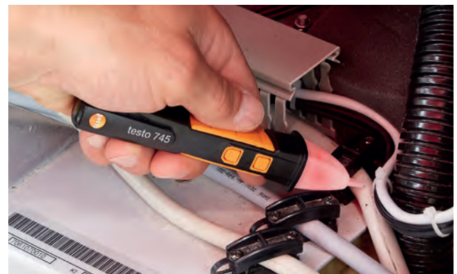
El testo 745 , resistente al agua y al polvo, es un instrumento para detectar la tensión sin contacto.
