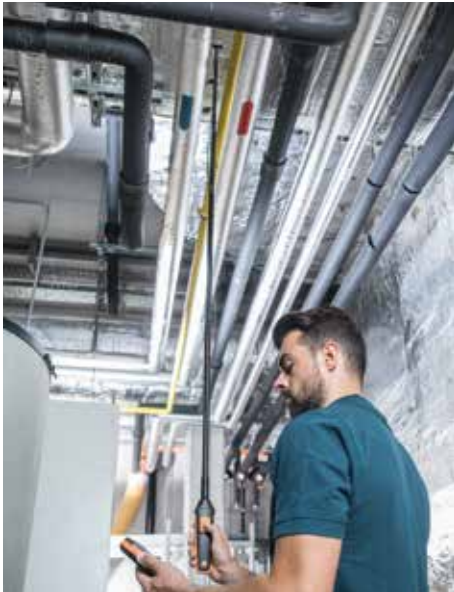
Pracę w kanałach wentylacyjnych ułatwią teleskopy, wyposażone z czytelną skalę. Dodatkowo, można je opcjonalnie przedłużyć od 1 do 2 m.
