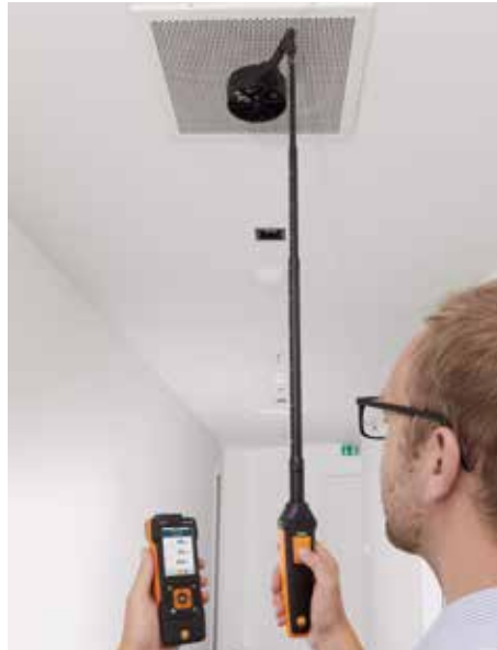
Pomiary na sufitowych kratkach wentylacyjnych bez konieczności użycia drabiny. Po prostu podłącz sondę wiatraczkową (Ø 100 mm) do teleskopu i przejściówki kątovej 90°.
