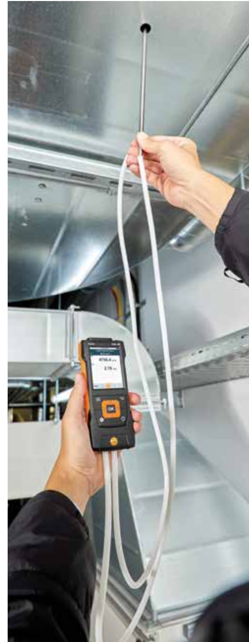
Do pomiarów strumienia objętości w przypadku dużych zanieczyszczeń lub dużych prędkości przepływu powietrza rekomendujemy testo 440 dP oraz rurkę Pitota.
