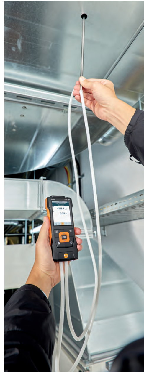
Voor het meten van debieten bij hoge stromingssnelheden of sterk verontreinigde stroming adviseren we de testo 440 dP en een pitotbuis.
