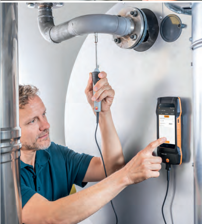
Met de testo 400 kunt u tot wel acht sondes (4 x bluetooth, 4 x kabel) tegelijkertijd gebruiken.
