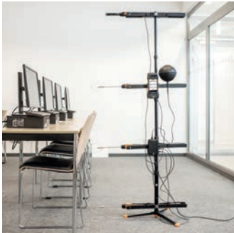
図7: testo 400を使って3段階全ての高さでの測定が可能
