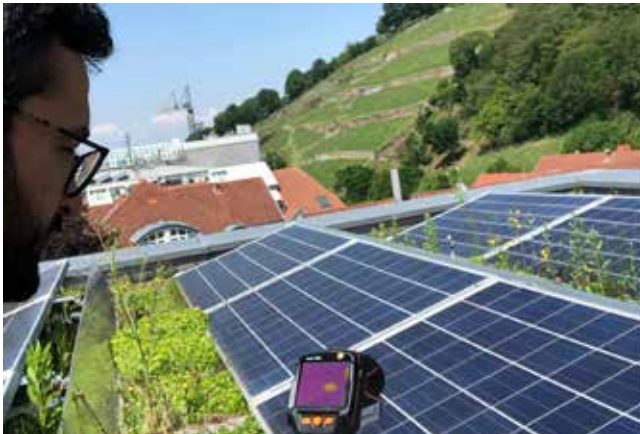
Figura 3: La termocamera testo 883 in uso per l'ispezione di un impianto fotovoltaico.
