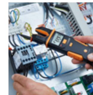
Misurazione della tensione di un compressore.
