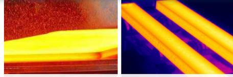
Controllo dei processi per le alte temperature fino a 1200 °C.
