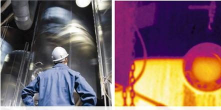
Controllo del livello di riempimento dei liquidi di processo.
