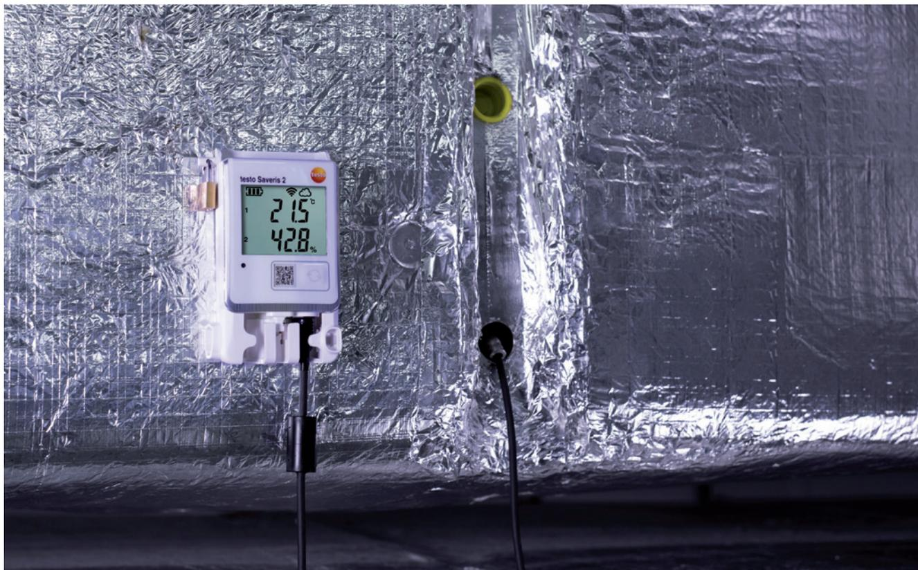
Une sonde radio testo Saveris 2 mesure la température et l'humidité dans une canalisation d'air.
